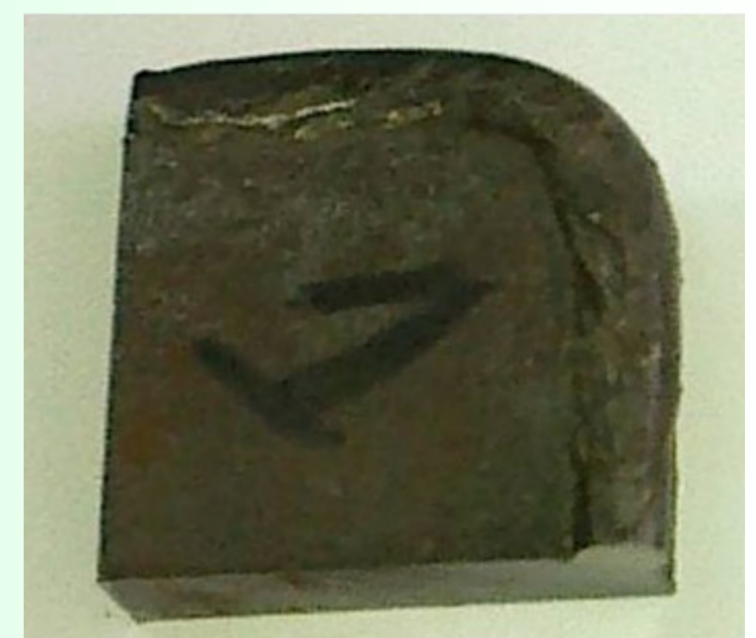
Fig.4. Aspectul macroscopic al depunerii sudate în cazul probei - Poanson stanța pentru decupare tablă
